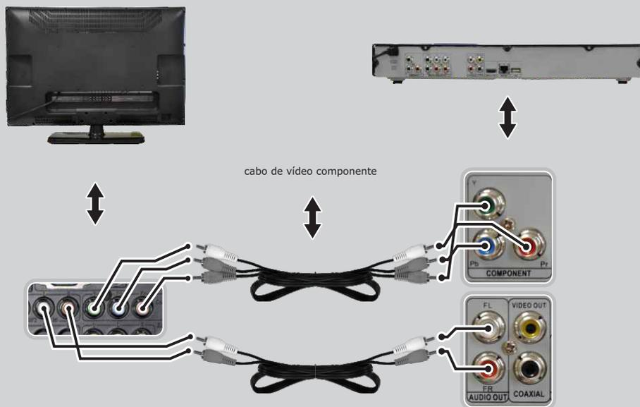
Deve-se coincidir as cores do plug com as cores das saídas e entradas.
