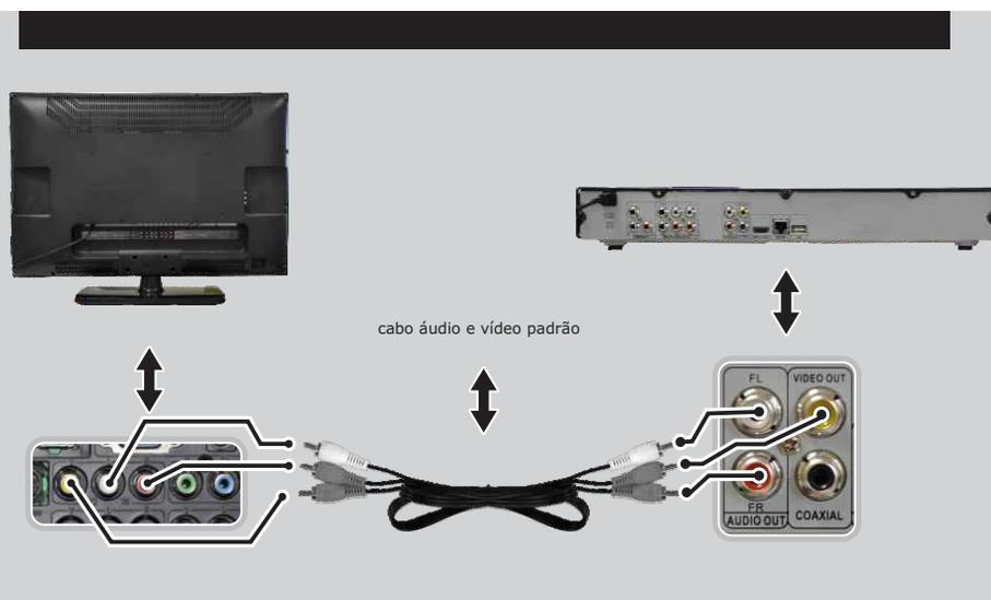
Deve-se coincidir as cores do plug com as cores das saídas e entradas.
