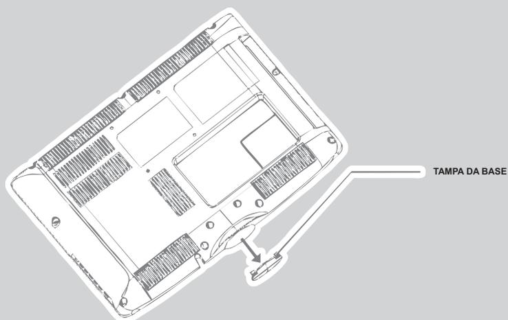
Posicionar a base com o engate na direção mostrada na figura abaixo e utilizar os 4 (quatro) parafusos fornecidos com o televisor para fixá-la.
